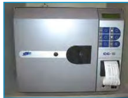
Fig. 5 : Autoclave, impression de la traçabilité.
