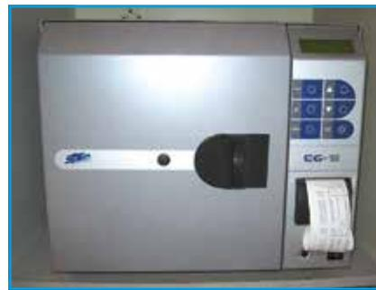
Fig. 5 : Autoclave, impression de la traçabilité.
