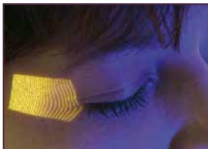
FIG. 1: Franges d'interférences sur la patte d'oie (18 × 13 mm<sup>2</sup>).
