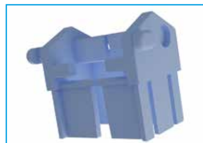
Fig. 3 : Butée de tiroir conçue pour les blocs opératoires de l'APHP, non disponible en pièce détachée sur le marché.
