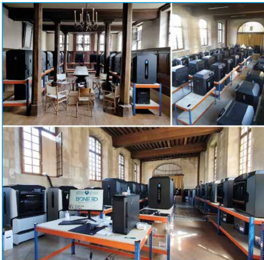
Fig. 1 : "Ferme" d'impression 3D de Port-Royal, mise en place en urgence fin mars 2020 durant le pic de la pandémie de COVID-19 : 60 imprimantes dépôt de fil actives nuit et jour pour répondre aux besoins de l'APHP.
