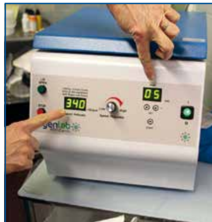
FIG. 3 : Centrifugation à 1500 g (équivalent pour cette machine à 340 *10 soit 3400 rotations par minute) pendant 5 minutes. Ces paramètres sont propres au kit et à la centrifugeuse Regen Lab®.
