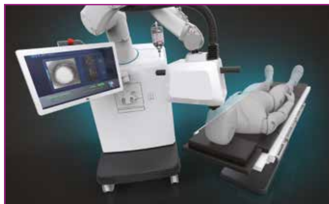
Fig. 16: Plateforme FemtoMatrix de KERANOVA. Le laser femtoseconde est déplacé par un bras robotisé qui revient automatiquement dans sa position de parking à la fin de la découpe. Le laser étant mobile et équipé d'un bras-robot, il peut s'intégrer dans le bloc opératoire, sans avoir à déplacer le patient, pour l'aspiration du cristallin avec un appareil de phaco classique. Une pièce à main et un système d'aspiration dédié devraient être à terme intégrés dans la plateforme pour réaliser la procédure, sans avoir besoin de machine complémentaire.
