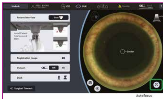
Fig. 5 : Vue interface utilisateur du laser ELITA. Chaque PI est scannée par la machine pour vérifier la bonne position et mesurer l'épaisseur du miroir d'aplatissement.
