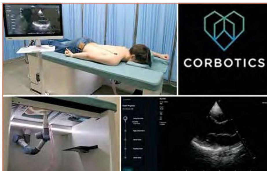
Fig. 2 : Échographie robotisée automatisée avec guidance par IA.
